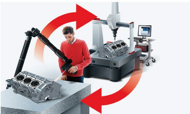
ทำการวัดชิ้นงานหลายชิ้นด้วยเครื่อง CNC CMM และเซนเซอร์แบบพกพา
